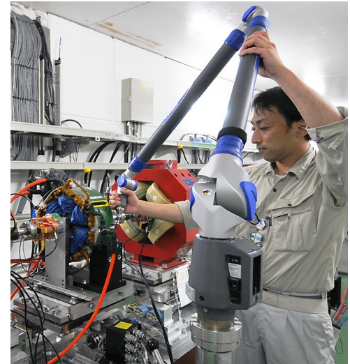
FAROアーム測量 (測定範囲直径 3 m)
