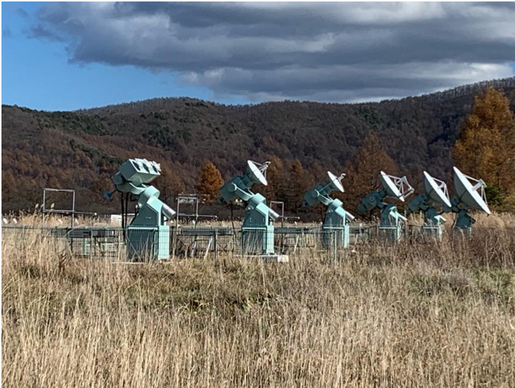
図1 :2021年 11月 10日に撮影された野辺山太陽電波強度偏波計（ NoRP ）の写真 左から、35/80GHz、17GHz、9.4GHz、3.75GHz、2GHz、1GHzの各アンテナ
