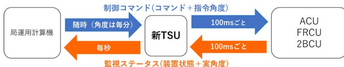
図 2-1 新 TSU が送受信するデータとタイミングのイメージ
