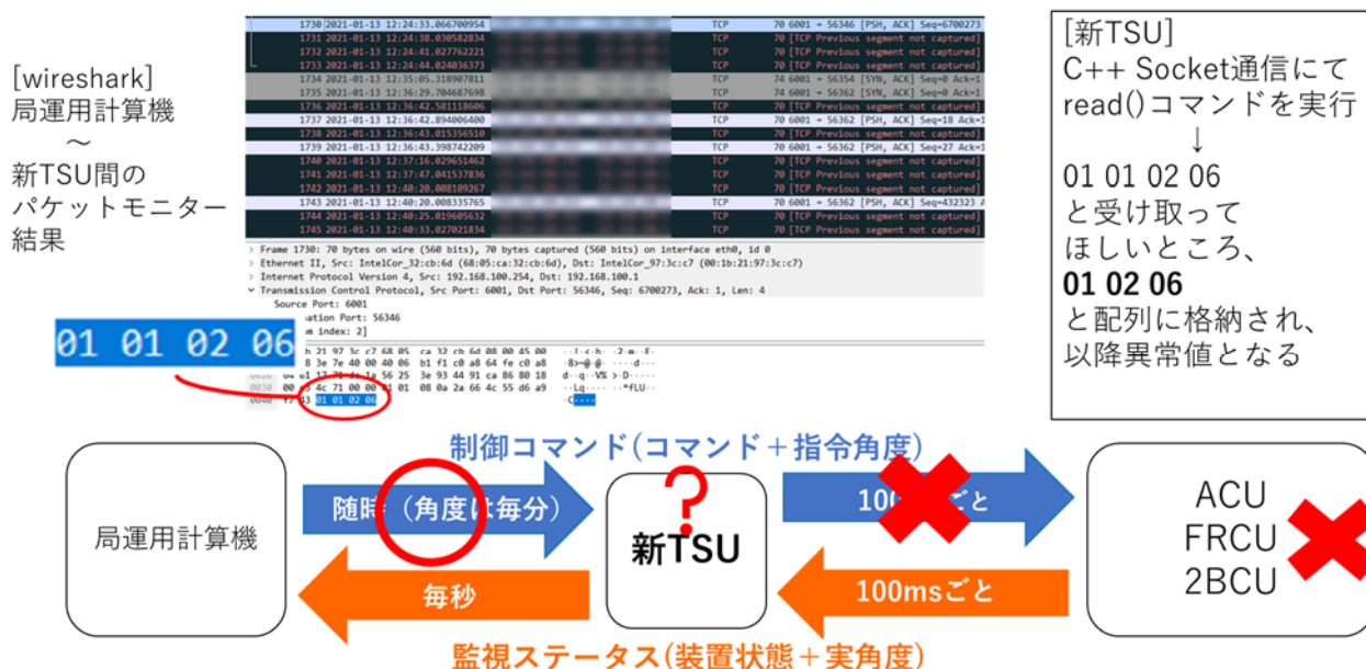
図 6-1 wireshark による制御コマンドパケットモニターの様子
