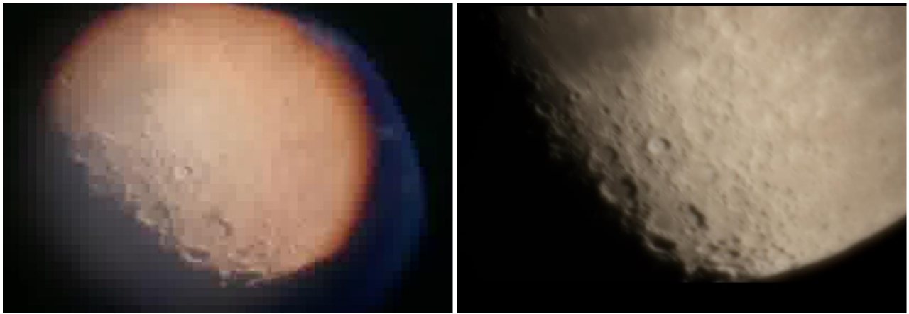
図 6 (左)国友望遠鏡で撮像された月面像。(右) シミュレーションで求めた点像関数を施した月面像。
