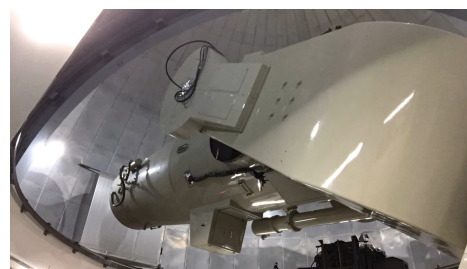
図3：木曽シュミット 105cm 望遠鏡
