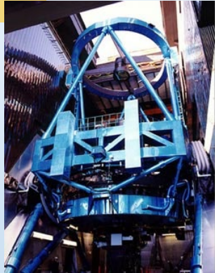
すばる 1999～ 口径8m光赤外線望遠鏡：世界最大級の大型一枚鏡を実現し、現在世界最高性能の解像度、追尾精度、広視野を持つ
