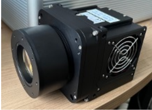
Fig. 1 (上)SCUIDの収差補正光学系設計. (右)補正光学系と検出器モジュールを組み合わせたSCUID本体.
