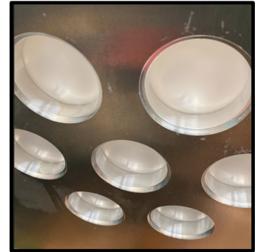
図 6：結露のないテフロン窓
