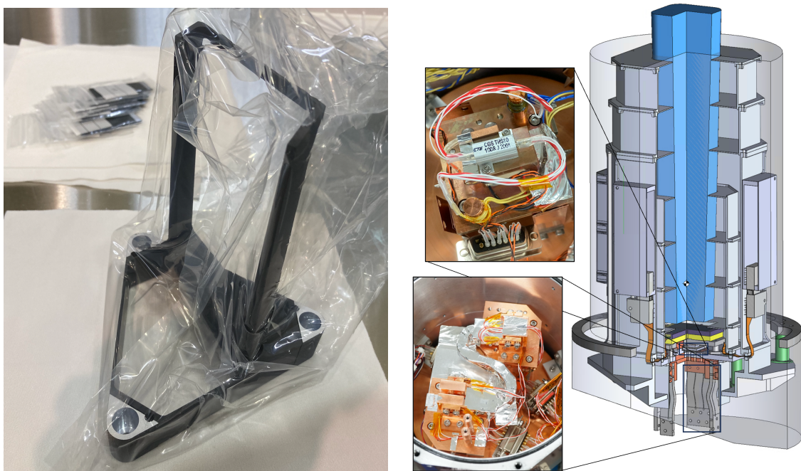
左：製作中の SOLAR-C 搭載部品(BBM)，うしろは表面処理の工程認定・管理用のクーポン
