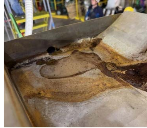
酸※による腐食（薬液滴下防止パン）
