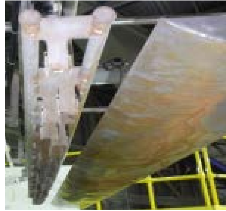
酸※による腐食（薬液滴下防止パン）
